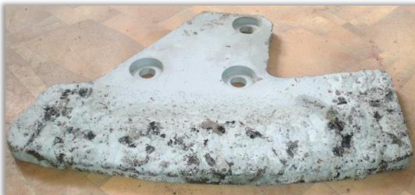
Рис. 2. Лопатка, наплавленная электродом Т590
